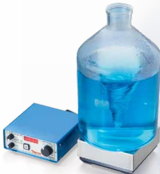
Cimarec Mobil 200 avec boîtier de commande Telemodul 40 M
